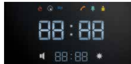
DS-2 als Empfängerwecker für HUMANTECHNIK-Signalanlagen: das Anzeige-Display mit großen, klar lesbare Ziffern und farbig leuchtenden Signalquellen-Symbole
